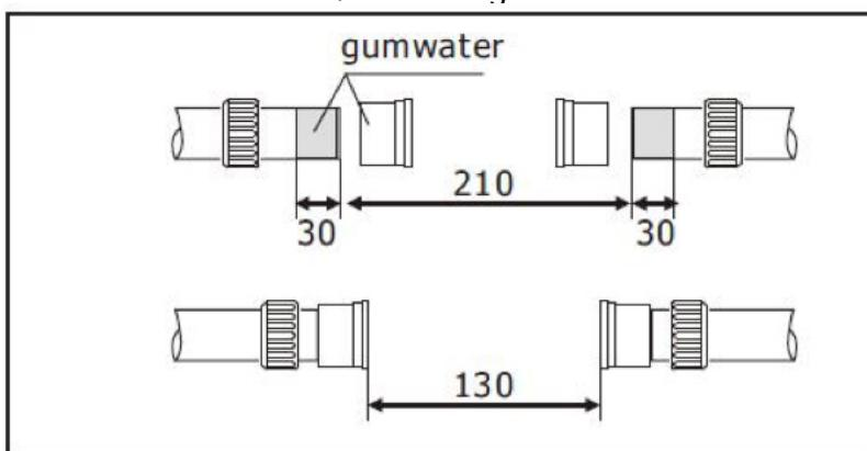
5. Installation des Wassererhitzers: (Abb. 5). Befestigen Sie den Schlauch an der Schlauchkupplung des Wassererhitzers. Bitte achten Sie darauf, dass die Verbindung ganz dicht ist. Bitte beachten Sie auch, dass die Komponenten aus Kunststoff bestehen und daher kaputt gehen
