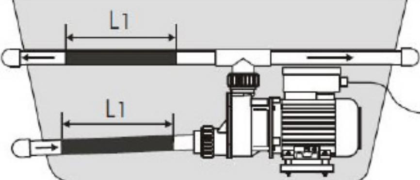
3. Rury PVC: (rys. 3) wyciąć odpowiedni kawałek rury PVC/wąża od dopływu/wylotu pompy
