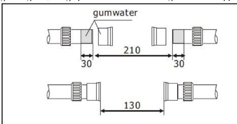
5. Installera värmaren (fig. 5) Montera slangen på värmarens slangkoppling. Se till att alla astdelar lätt kan gå sönder.
