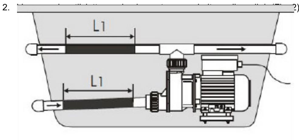
3. PVC rør: (fig 3) Skær et passende stykke PVC rør/slange fra pumpens udløb/returløb og
