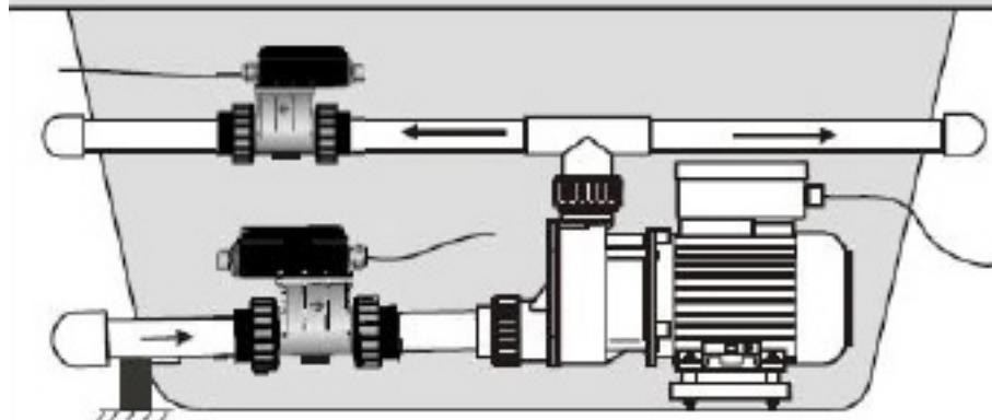
**HINWEIS:** Das Anschlussrohr bzw. der Anschlussschlauch muss den gleichen Durchmesser haben wie der Rest des Rohrsystems im Spa/Wildmarksbad.
