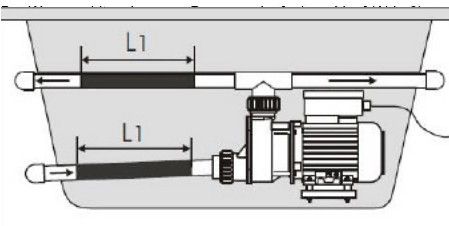
Die Abstände zwischen den Anschlüssen müssen mit  $L_1$  geschlossen werden.
