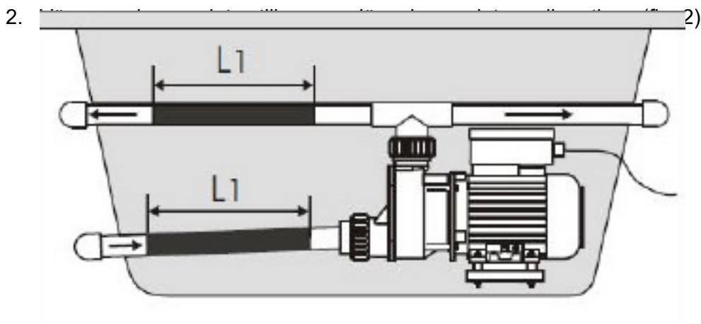
3. PVC slang (fig. 3) Skär till en passande bit PVC slang från pumpens intag eller utlopp och
