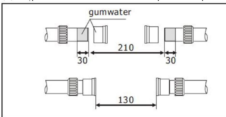
5. Installation af varmer: (Fig. 5) Montér slangen til varmerens slangekobling. Vær opmærksom på at samlingen er helt tæt. Vær endvidere opmærksom på at komponenterne er i plast-
