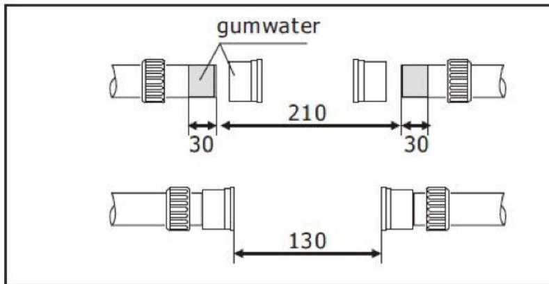
5. Instalacja podgrzewacza: (Rys. 5) Przeprowadź montaż węża do złącza węża na podgrzewaczu. Należy pamiętać, że pobieranie jest całkowicie szczelnie zamknięte. Należy również pamiętać, że komponenty są wykonane z tworzywa sztucznego, a zatem można je uszkodzić,
