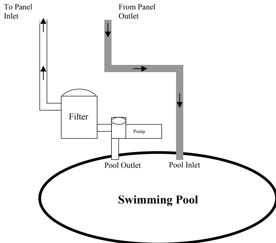
4. Zorg ervoor dat uw slangen allemaal op de juiste manier zijn aangesloten en dat alle de moffen zijn aangedraaid. Deblokkeer de inlaat en uitlaat van uw zwembad.
