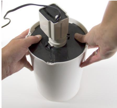
Verwijder de zwarte montageplaat door deze tegen de klok in te drukken. **BELANGRIJK: Vermijd het de motor beet te pakken. Dat zal de veer aan de binnenkant beschadigen.**
