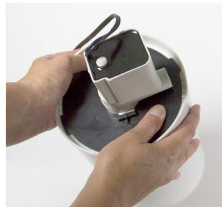
Drehen Sie die schwarze Montageplatte auf, indem Sie sie im Uhrzeigersinn drücken, bis sie in der Kante des Pumpengehäuses arretiert ist. **WICHTIG: Fassen Sie den Motor nicht an. Das kann die darin befindliche Feder beschädigen.**
