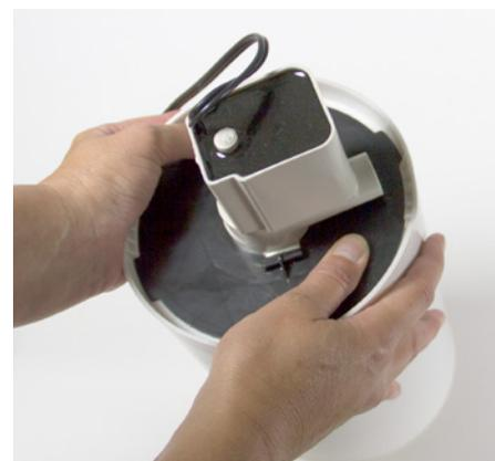
Vrid fast den svarta monteringsplattan genom att trycka den medsols tills den låser fast i pumphusets kant. **VIKTIGT!** Undvik att ta på motorn. Det förstör fjädern inuti.
