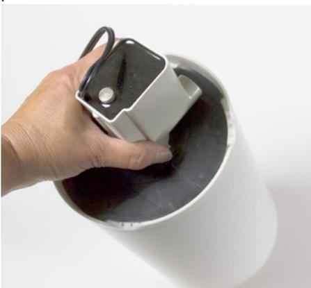
Setzen Sie Filter und Motor in das Pumpengehäuse, sodass die Aussparungen an der Kante der Montageplatte mit der Kante des Pumpengehäuses fluchten.
