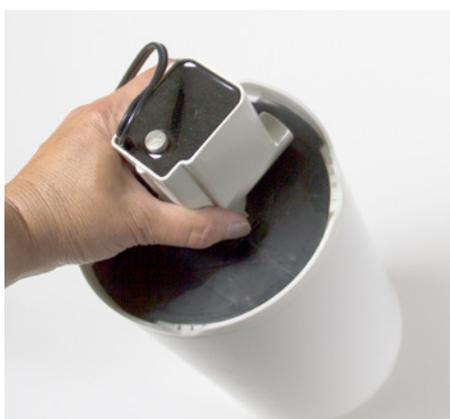
Placér filter og motor i pumpehuset, så hakkerne i kanten af monteringspladen, passer i pumpehusets kant.
