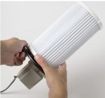
Schroef het filter weg door de onderste plastic rand beet te pakken en deze tegen de klok in te draaien tot het filter loskomt van de zwarte montageplaat.
