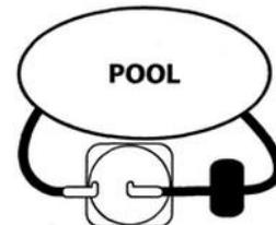
Din pool pump och 2 solvarmer ansluten. (Solvarmeren måste monteras på returloppet från din pump så vattnet strömmar från pumpen genom solvarmeren och tillbaka i poolen)
