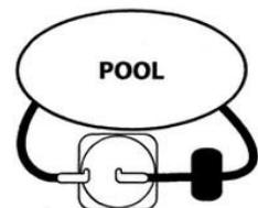
Altaan pumppu ja 2 Aurinkolämmitin kytketty. (Aurinkolämmitin laittaa paluuputki pumppu niin vesi virtaa pumpun kautta solvarmeren ja takaisin altaaseen)
