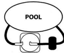
Din pool med pumpe og 2 solvarmer tilsluttet. (solvarmeren skal sættes på returløbet fra din pumpe så vandet løber fra din pumpe gennem solvarmeren og tilbage i poolen)
