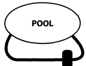
Dit basseng med pumpe og 1 st. solvarmeanlæg. (Solvarmeanlægget skal sættes på returløbet fra din pumpe så vannet fra pumpen gjennom solvarmeanlægget og tilbake i bassenget)
